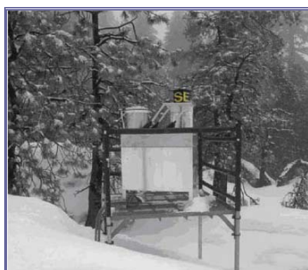
Σχήμα 15: Δειγματολήπτης υγρού εναποτιθέμενου Hg στο σταθμό του Sequoia National Park Mercury Deposition Network, στην Καλιφόρνια των ΗΠΑ. (Πηγή: UNEP, 2008)
