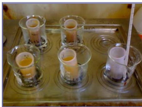
Σχήμα 23: Οι δειγματοφορείς είναι εμβαπτισμένοι μέσα σε υδατόλουτρο κατά το τρίτο και τέταρτο στάδιο των διαδοχικών εκχυλίσεων.
