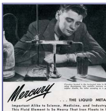
Σχήμα 6: Μεταλλικός υδράργυρος προκύπτει από την θέρμανση του κινναβαρίτη σε ειδική πειραματική διάταξη. (Πηγή: Popular Science Magazine, September 1944)
