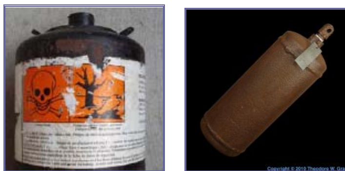
Σχήμα 5: Σιδερένια δοχεία για την αποθήκευση και μεταφορά του μεταλλικού Hg. (Πηγή: διαδίκτυο)
